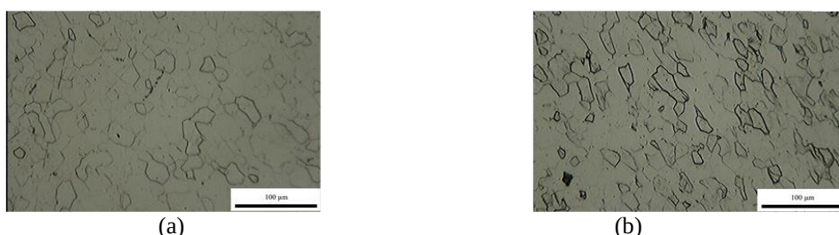
Figura 4. Micrografias da chapa de aço utilizadas no trabalho: (a) Sessão longitudinal e (b) Sessão transversal.
