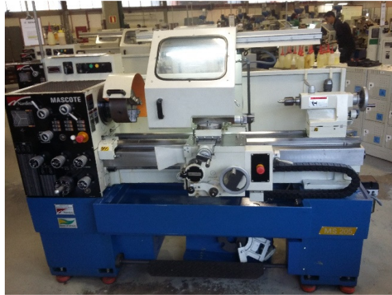
Figura 5. Torno mecânico Nardini Mascote MS-205.
