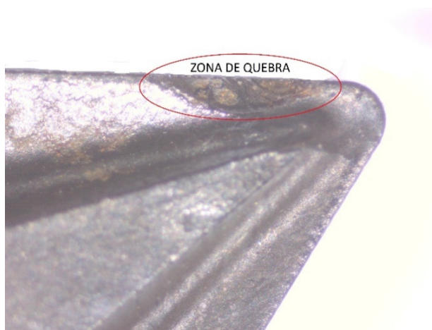
Figura 10. Inserto utilizado no corte a seco com velocidades reduzidas (SR).
