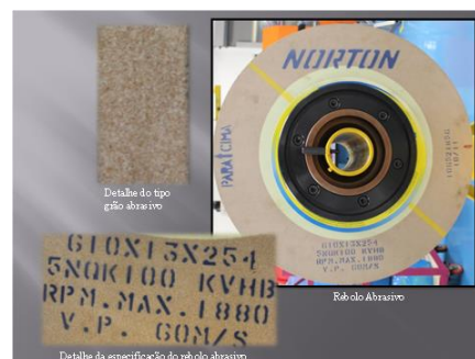
Figura 4 – Rebolo abrasivo NORTON® utilizado no experimento de retificação
