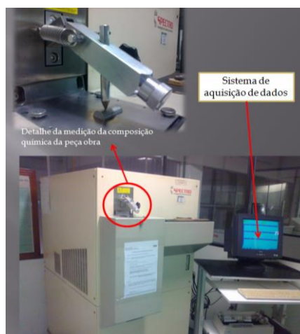
Figura 7 – Equipamento “Spectro” para caracterização de matéria-prima da peça
