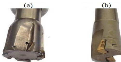
Figura 7. (a) Fresa com 40 mm de diâmetro, e (b) Fresa com 20 mm de diâmetro
