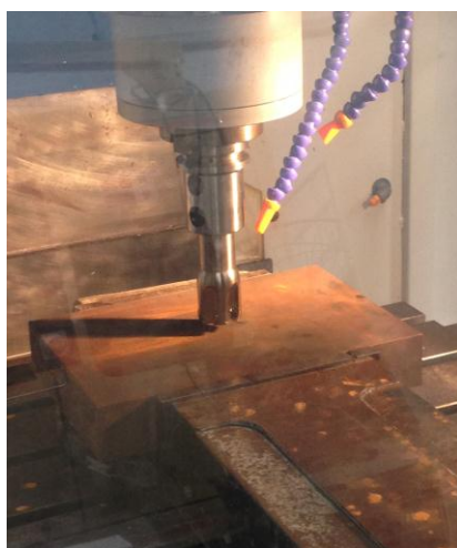
Figura 6. Bloco de aço AISI P20 preparado para a usinagem
