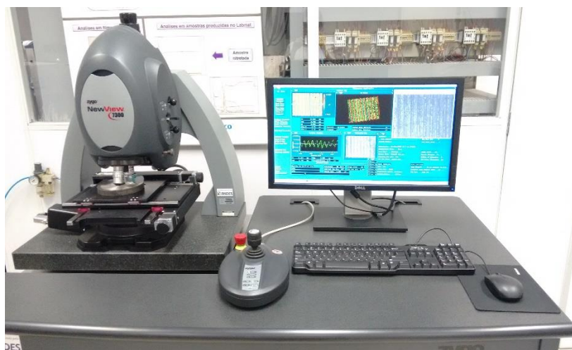
Figura 5. Interferômetro de luz branca para medição de rugosidade 3D.
