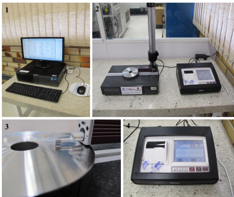
Figura 1. Etapas para medição da rugosidade 2D.
