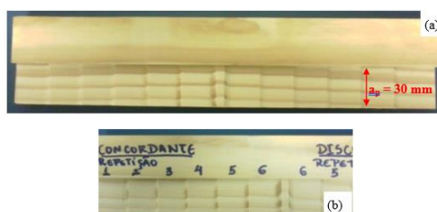
Figura 3. (a) corpo de prova após a usinagem, com a demonstração da largura de corte; (b) corpo de prova com os sentidos de corte e as repetições das usinagens.
