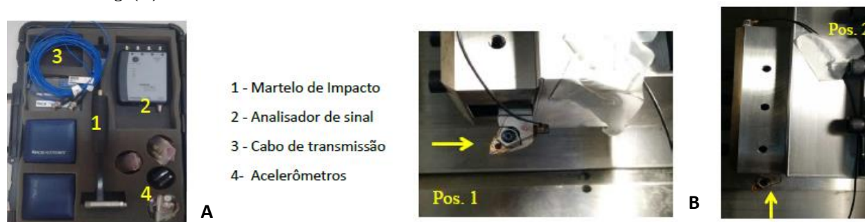
Figura 8. (A) Kit para análise modal experimental e (B) posicionamento dos acelerômetros para o teste.
