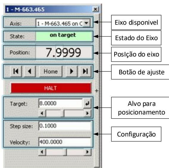
Figura 8. Painel de controle da mesa de elevação (eixo vertical).
