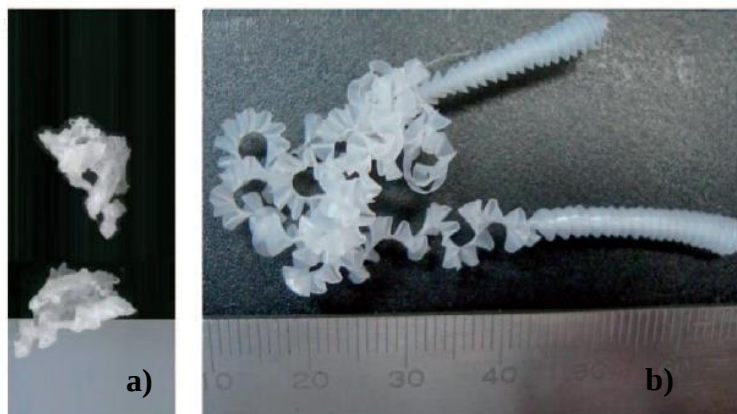
Figura 2. Cavacos obtidos na furação de PA66 para a velocidade de corte 63 m/min sob diferentes avanços: a) 900 mm/min b) 1000 mm/min (GAITONDE et al. , 2011).
