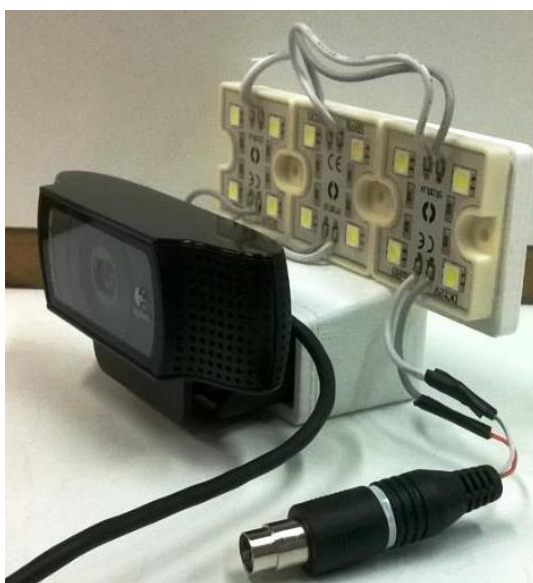
Figura 5 – Câmera e módulos de led presos ao suporte.
