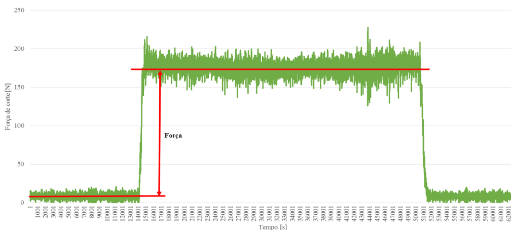
Figura 4. Representação da medição de força relativa utilizada nos ensaios.
