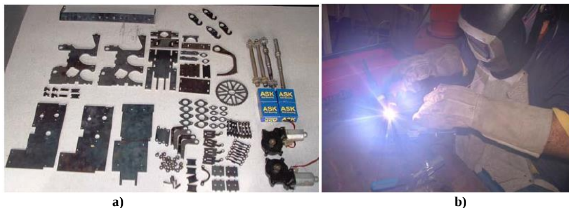
Figura 3. Plataforma robótica criada a partir do modelamento do objeto em lâminas. a) Peças após o corte a laser e b) montagem com o processo TIG. Fonte: Ramalho filho et al, 2007.
