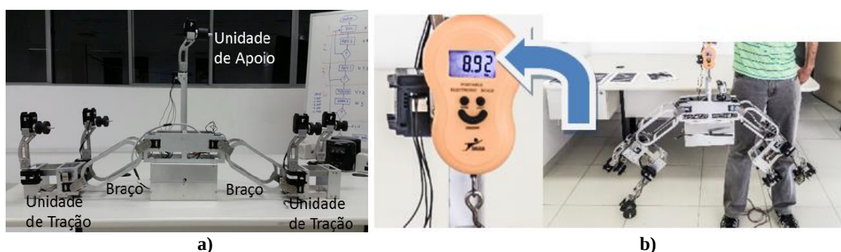
Figura 4. Plataforma POLIBOT: a) sistema robótico fabricado a partir da metodologia MFP e b) massa de aproximadamente 9kg do robô. Fonte: Bomfim et al 2015.
