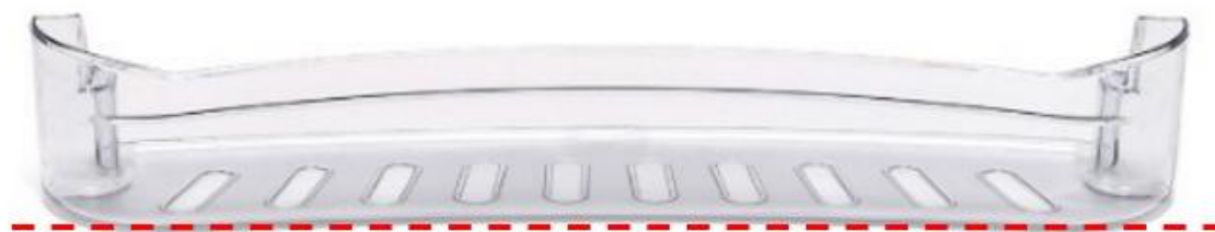
Figura 2. Face Plana Inferior para medir o Empenamento em destaque com linha tracejada
