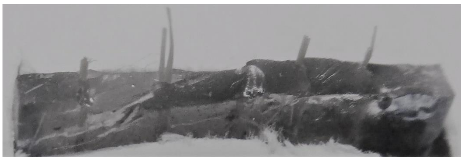
Figura 8. Superfície de fratura para os compósitos com espaçamento entre fibras de 2,5mm ( \lambda_x = 2,5 mm).
