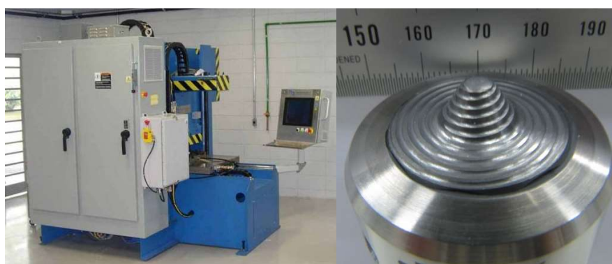
Figura 1– Máquina RM-2 de SAPNC pertencente ao Laboratório Nacional Nanotecnologia (à esquerda) e ferramenta de PCBN-WRe (à direita).
