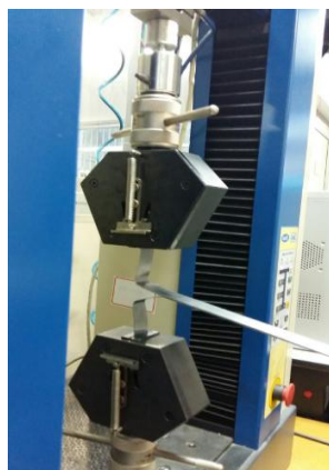
Figura 7. Ensaio de desprendimento na máquina de tração
