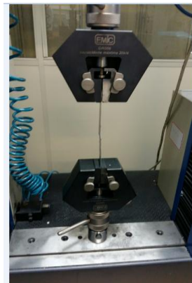
Figura 11 – Ensaio de cisalhamento na máquina de tração
