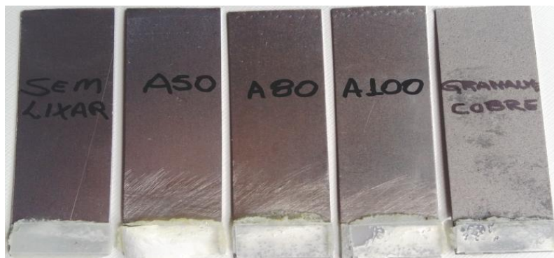
Figura 17 – Superfície após o teste de cisalhamento para diferentes rugosidades.
