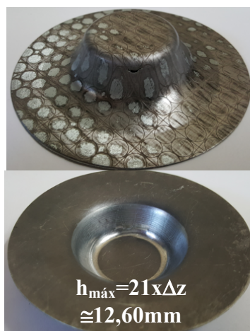
Figura 7. Corpos de prova deformados com d_t = 6\text{mm} e \Delta z = 0,6\text{mm}
