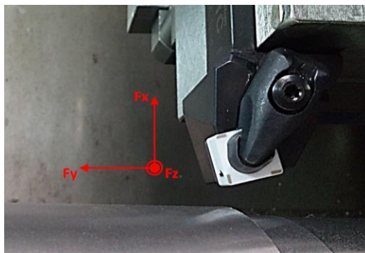
Figura 2. Componentes ortogonais de força de usinagem ( F_x , F_y e F_z ).
