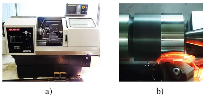
Figura 2. a) Torno CNC Nardini Logic 175; b) Detalhe de um experimento (Fonte: autoria própria).
