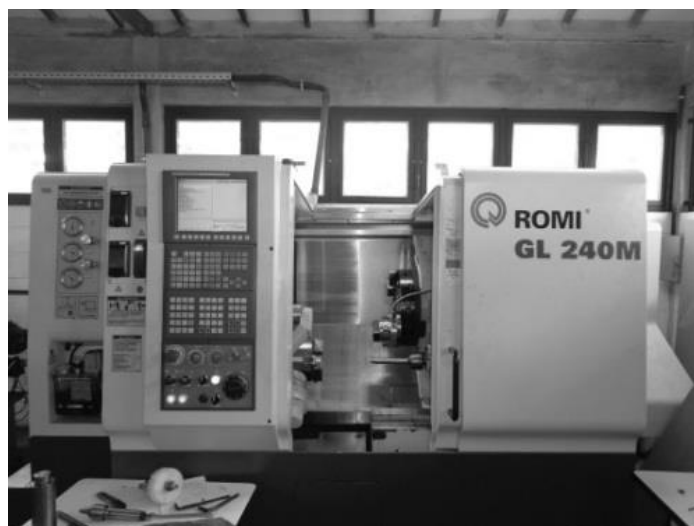
Figura 2. Centro de torneamento Romi GL 240M.
