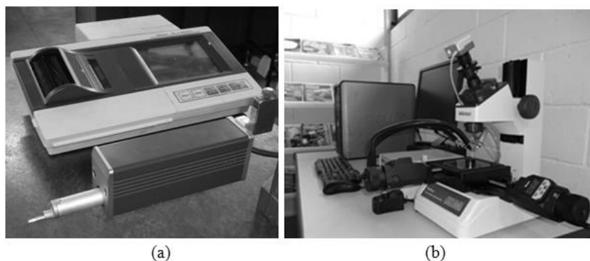
Figura 4. (a) Rugosímetro surftest SJ-400 Mitutoyo; (b) Microscópio Mitutoyo TM-500 com câmera Moticam 2300.
