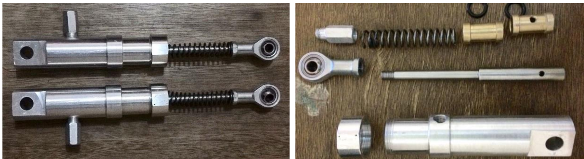
Figura 8. Cilindros mestres fabricados por usinagem.
