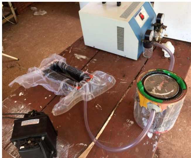
Figura 3. Fabricação do pedal mediante processo de laminação a vácuo.
