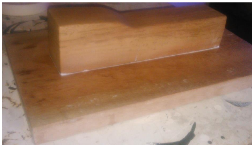
Figura 4. Modelo do pedal de freio fabricado em madeira, após aplicação dos desmoldantes. Fonte: dos autores.
