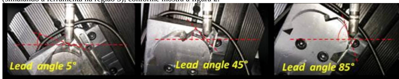
Figura 2. Corpo de prova e ângulo da direção de avanço
