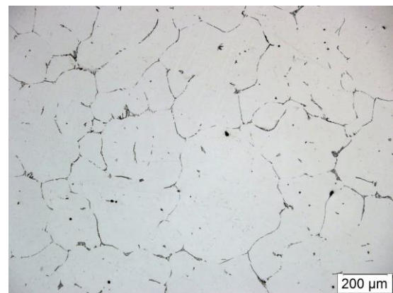
Figura 8. Poros distribuídos uniformemente na amostra em molde fechado.
