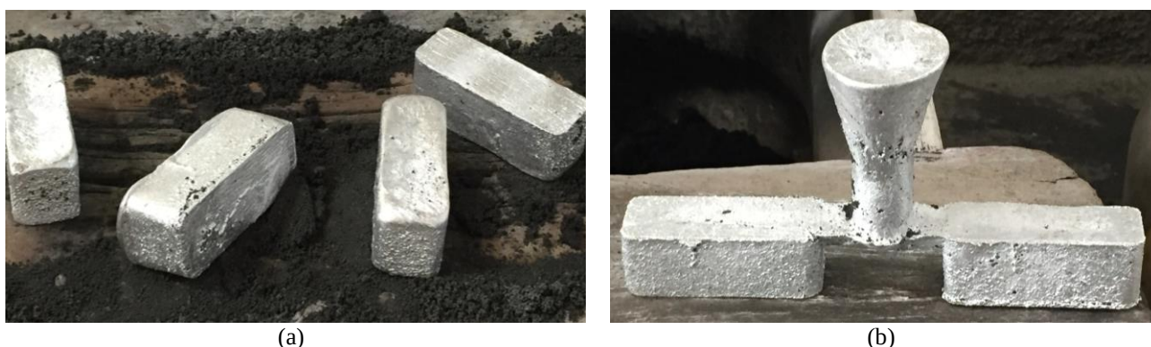
Figura 1. Amostras fundidas em (a) molde aberto e (b) molde fechado.
