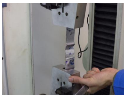
Figura 8 - Ensaio de cisalhamento executado nas juntas soldadas.
