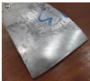
Figura 14 - Aspecto visual da parte externa da junta com a utilização do parâmetro 5 ( F = 0,8 kN; t = 45 ms; I = 6,2 kA; sentido corrente(-)).
