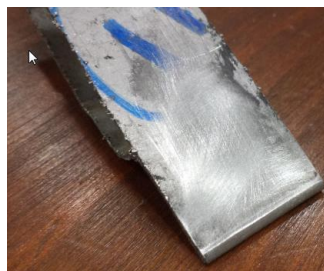
Figura 13 - Aspecto visual da parte externa da junta com a utilização do parâmetro 4 ( F = 0,8 kN; t = 45 ms; I = 7 kA; sentido corrente (+)).
