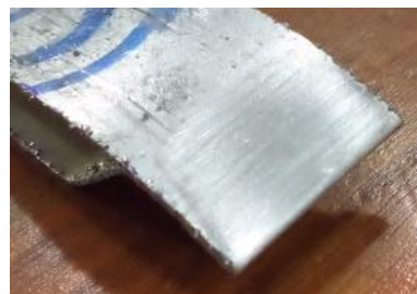
Figura 11 – Aspecto visual da parte externa da junta com a utilização do parâmetro 2 ( F = 1,4 kN; t = 45 ms; I = 6,2 kA; sentido corrente(+)).
