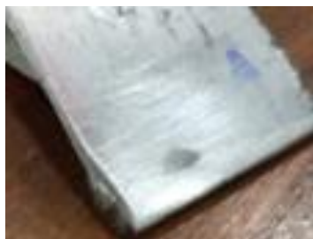
Figura 12 - Aspecto visual da parte externa da junta com a utilização do parâmetro 3 ( F = 0,8 kN; t = 90 ms; I = 6,2 kA; sentido corrente(+)).
