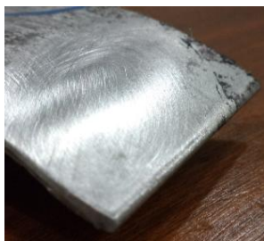
Figura 10 – Aspecto visual da parte externa da junta com a utilização do parâmetro 1 F = 0,8 kN; t = 45 ms; I = 6,2 kA; sentido corrente(+)).
