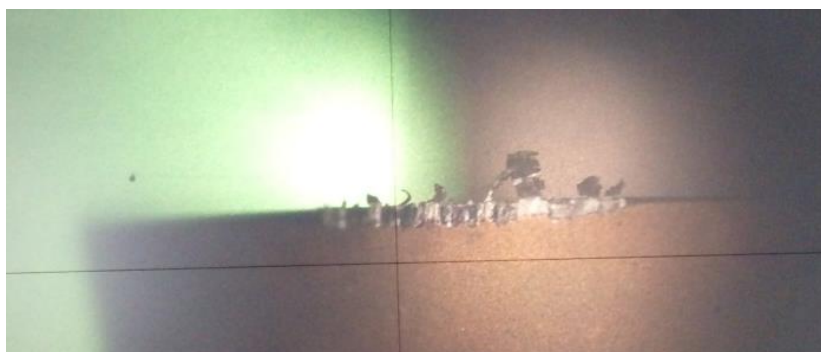
Figura 5. Formação de aresta postiça após 3º passe.
