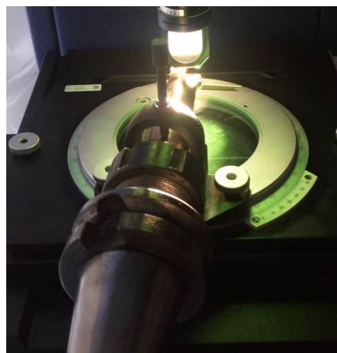
Figura 4. Verificação do desgaste do inserto.
