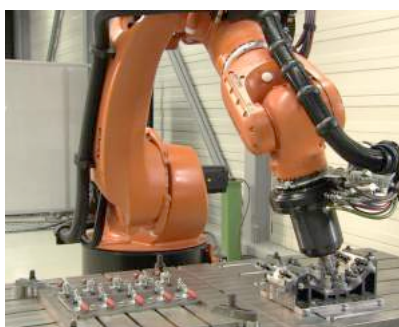
Figura 5. Robô industrial de braço articulado da Kuka, executando FSW.
