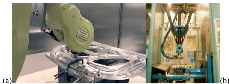
Figura 4. (a) Robô FSW numa peça de múltiplas soldagem (b) Robô Cinemático Paralelo. Fonte: Associação Brasileira de Soldagem.
