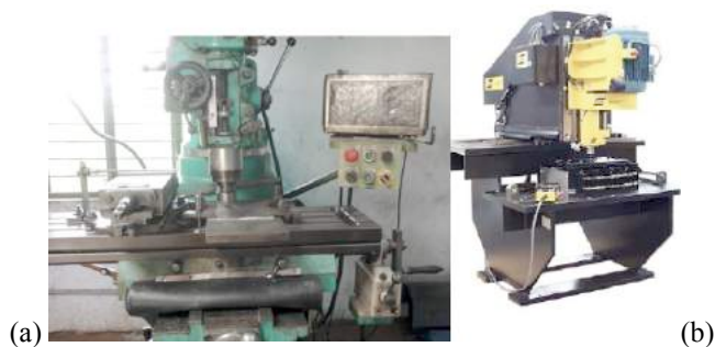
Figura 3. (a) Fresadora modificada para executar FSW. (b) Máquina dedicada para FSW. Fonte: Associação Brasileira de Soldagem.
