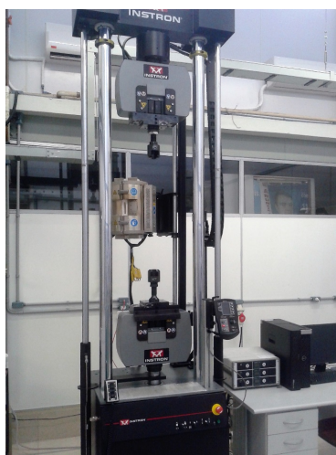
Figura 2. Máquina de ensaio de tração marca INSTRON modelo LX300.
