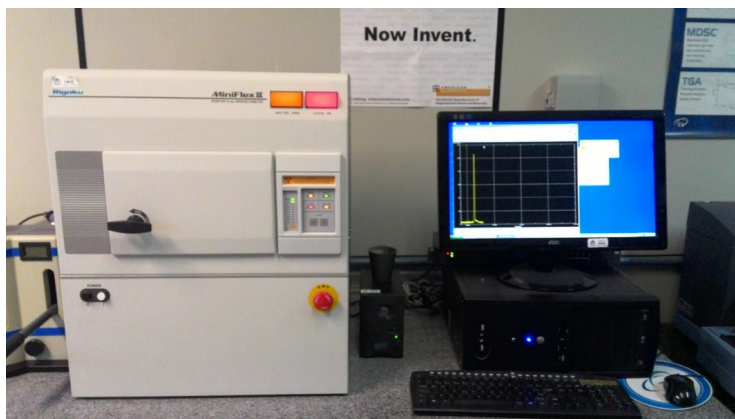
Figura 5. Difratometro de Raios x RIGAKU modelo MINIFLEX II.
