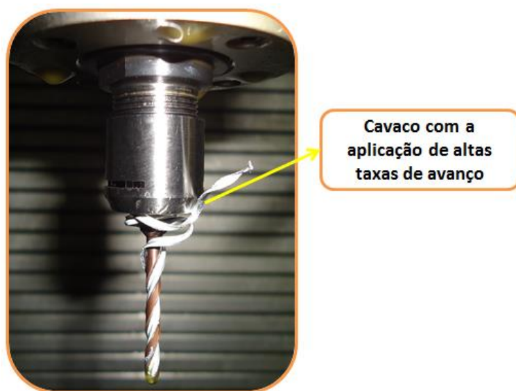
Figura 8. Cavaco com a aplicação de altas taxas de avanço. (Fonte: Autoria Própria)
