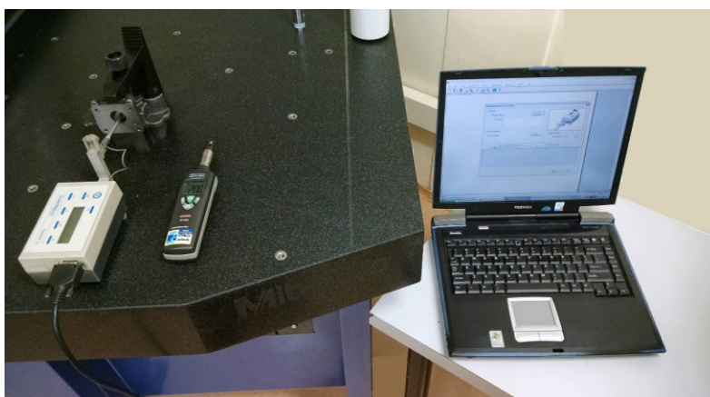
Figura 5. Rugosímetro portátil Surtronic 3+ da Taylor Hobson posicionado na mesa de desempenho da máquina de medir por coordenadas.
