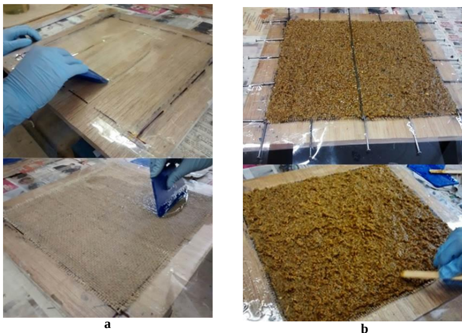
Figura 1 – Técnica de laminação manual. Em a , o início do processo de laminação ocorrendo por meio do despejo da resina sobre o tecido de juta. Em b , está representado a técnica de espalhamento duplo.
