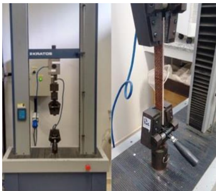
Figura 4 – Máquina universal KRATOS utilizada nos ensaios tração.
