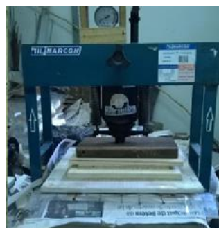
Figura (5) e (6) – união das duas bases de madeira e a aplicação da pressão de uma tonelada, respectivamente.
