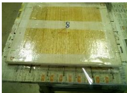
Figura (5) e (6) – união das duas bases de madeira e a aplicação da pressão de uma tonelada, respectivamente.
