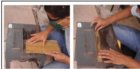
Figura 13. Execução do corte dos corpos de prova de acordo com a norma ASTM 3039.
