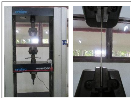
Figura 15. Procedimento do ensaio de tração de compósito de matriz poliéster reforçado por fibra do buçú.
