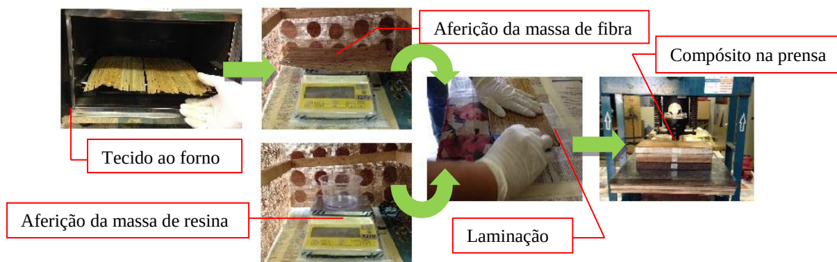
Figura 10. Fluxograma para obtenção dos compósitos de matriz poliéster e fibra da palha do Ubuçú.
