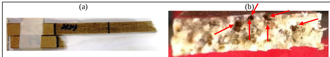
Figura 11. Aspecto da fratura do laminado Juta/Juta/Juta (a) Corpo de prova ensaiado (b) Superfície de fratura.
