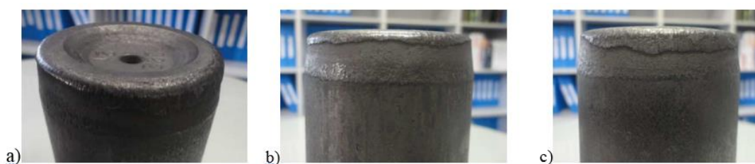
Figura 5 - Punção com revestimento de Carboneto de Cromo: (a) Vista em perspectiva; (b) Vista lateral 1; (c) Vista lateral 2.
