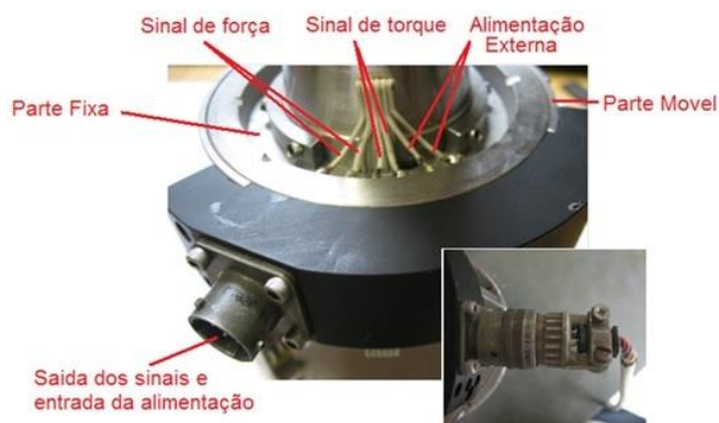
Figura 3. Anel deslizante Slip Ring. Fonte: Elaborada pelo autor
