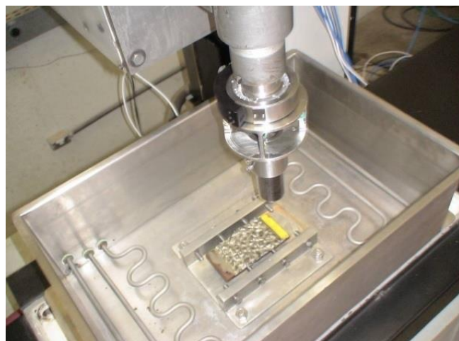
Figura 1. Detalhe do dinamômetro de contato deslizante montado no eixo-árvore sobre a cuba e fluxograma em malha fechada do sistema de mensuração (VILARINHO et al (2005)). Fonte: Elaborada pelo autor
