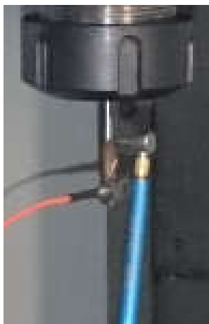
Figura 4. Coleta da frequência natural do balanço das ferramentas com o auxílio de um acelerômetro e martelo de impacto.
