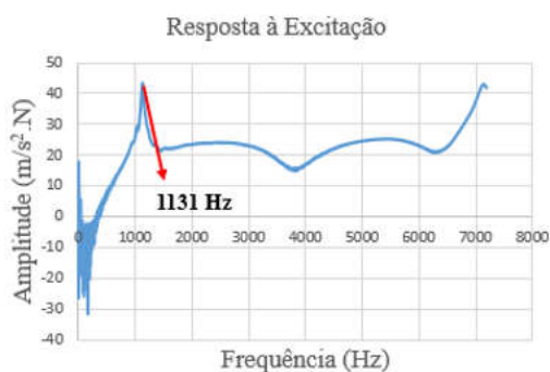
Figura 5. Frequência natural do conjunto de fixação do cone porta-pinças e ferramenta em 33 mm.
