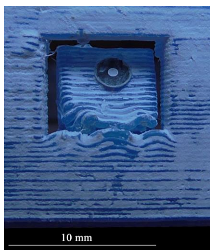
Figura 8. Encaixe entre os elementos macho e fêmea 8 .
