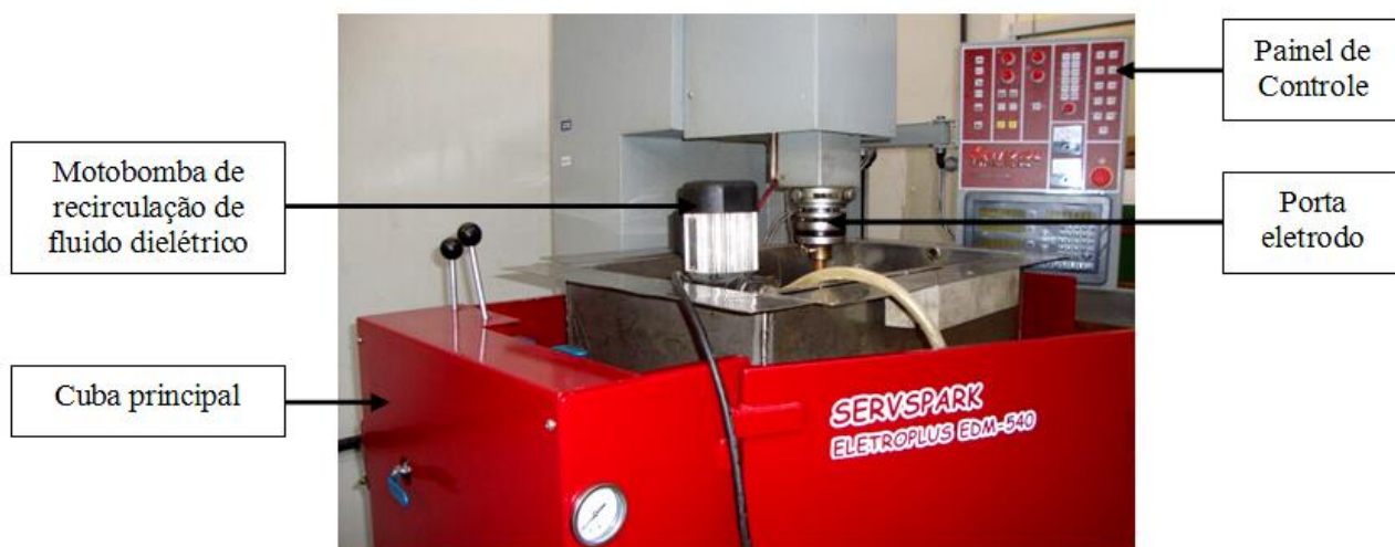
Figura 4. Cuba auxiliar instalada dentro da cuba principal da máquina EDM.
