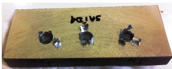
Figura 2. Corpo de prova após ensaios de furação para análise de rebarbas
