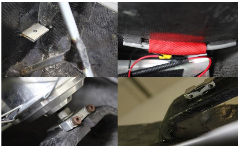
Figura 2. Componentes dos carros da equipe EFICEM unidos com fibra de carbono, micro esferas fenólicas e resina epóxi. Fonte: O autor (2016).
