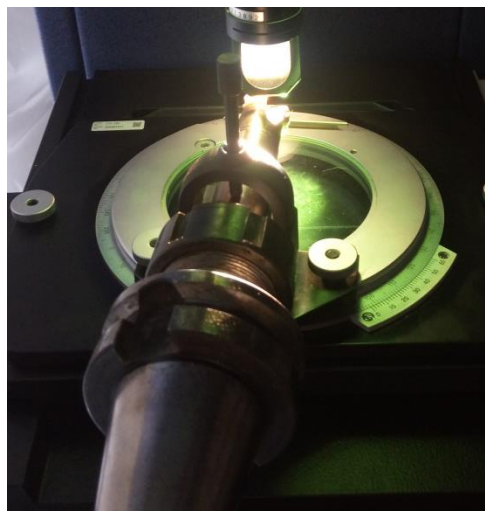
Figura 4. Verificação do desgaste do inserto.
