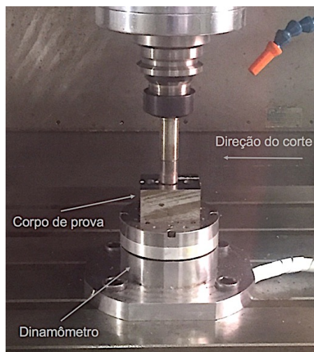
Figura 1. Configuração do corpo de prova para o ensaio de força de usinagem.
