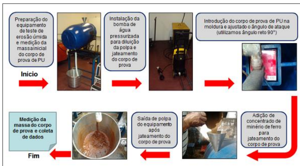
Figura 2. Fluxo esquemático com as etapas do ensaio de erosão úmida definidas para o trabalho.
