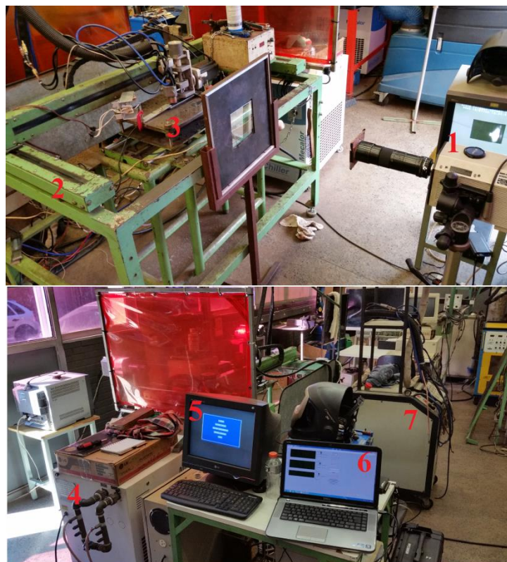
Figura 6. Banca Experimental. (1) Sistema de Filmagem; (2) Mesa de coordenadas X-Y, (3) Mesa de coordenadas para deslocamento da chapa; (4) Unidade de Refrigeração; (5) Sistema de Controle da mesa de Coordenadas; (6) Sistema de Aquisição; (7) Fonte de Soldagem.
