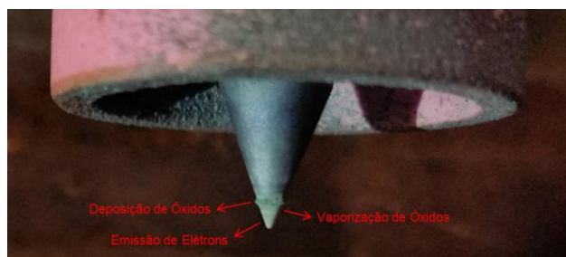
Figura 8. Ponta do eletrodo de tungstênio após a execução da soldagem (Teste 1)
