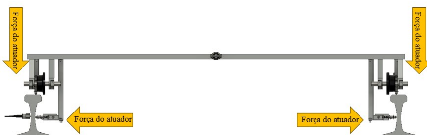
Figura 2: Visão frontal do carrinho com representação da atuação do atuador.
