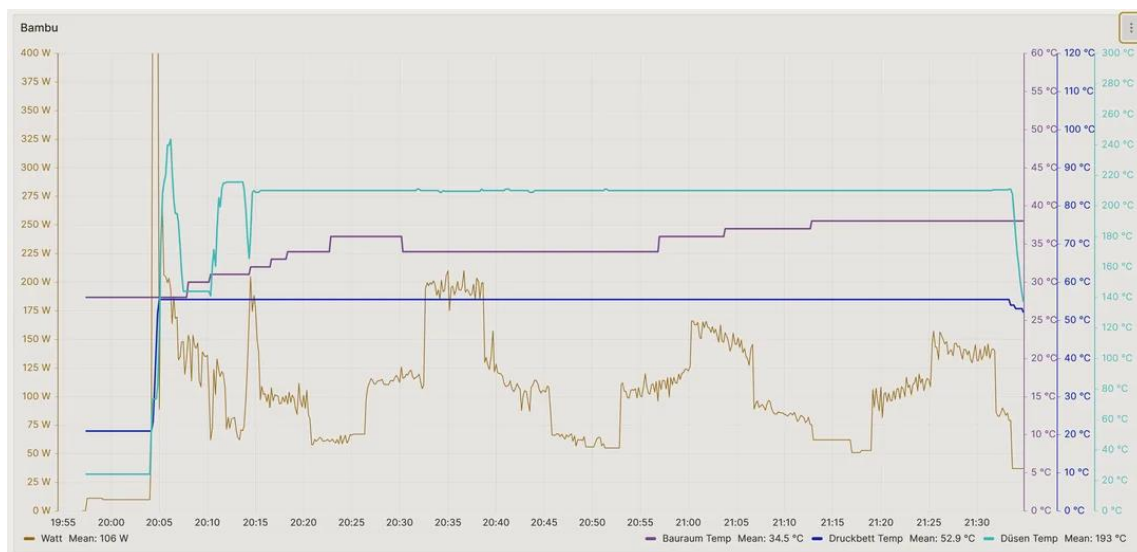
Figura 1 - Perfil de consumo de energia e variação térmica na Bambu Lab X1C durante impressão de PLA, Fonte: U/JULIAN-EXPLICIT
