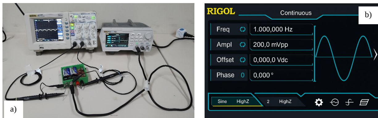
Figura 7. a) Primeira validação usando gerador de sinais e osciloscópio, b) Gerador de sinal com a configuração da onda senoidal
