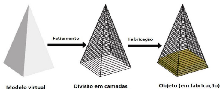
Figura 1. Funcionamento da Manufatura Aditiva (Araújo, 2021).
