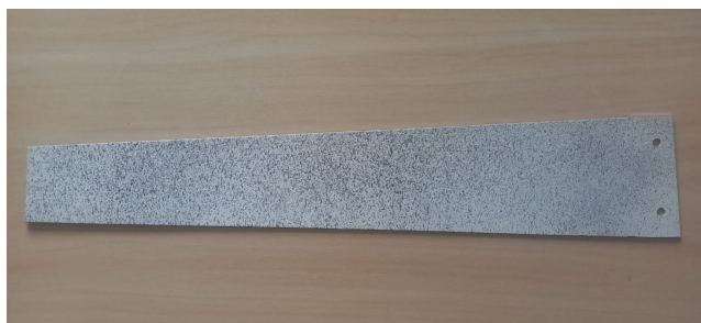
Figura 1. Placa de aço texturizada para avaliação de características dinâmicas a partir de ensaios assistidos pela técnica de CID
