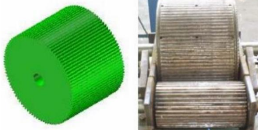
Figura 2. Elemento cilíndrico dentado (Silva, 2008)
